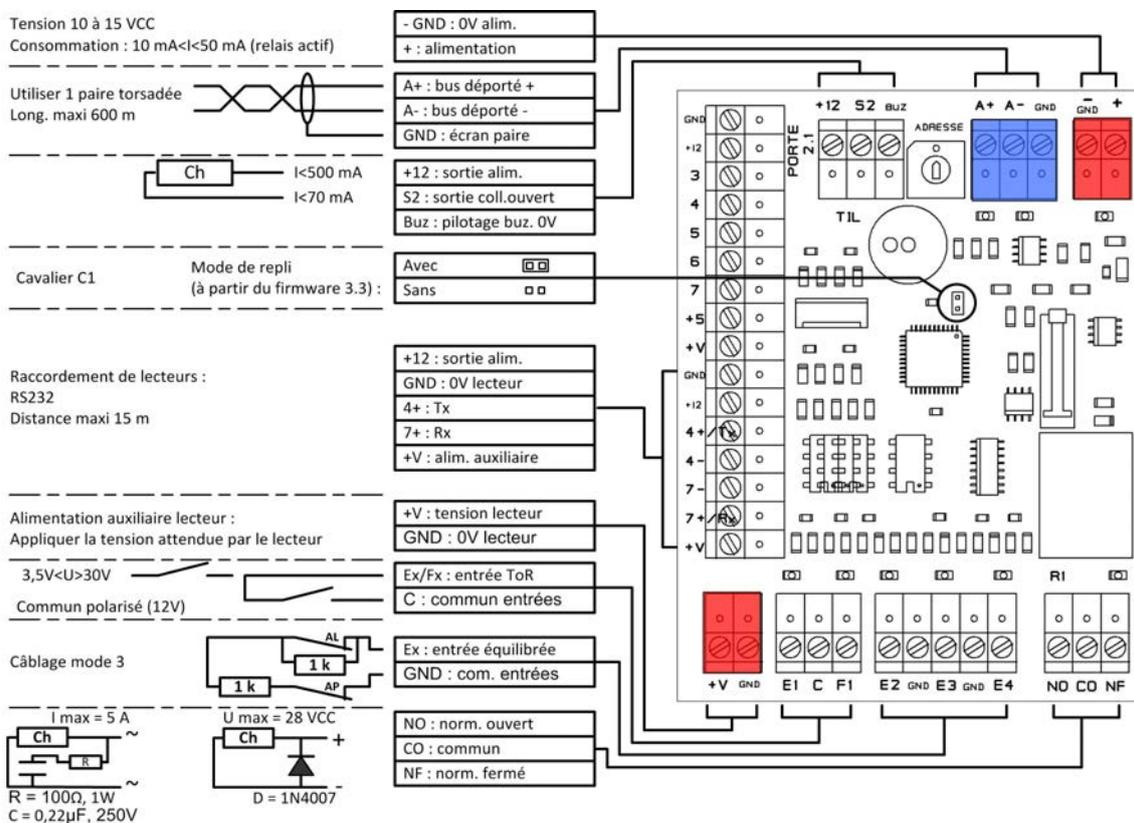
En mode de repli, le relais de commande est alimenté dès que le module est sous tension et le bus correctement raccordé à l'UTL. Assurer la connexion du mécanisme de verrouillage en sécurité positive en câblant l'équipement entre les bornes CO et NO du relais.
